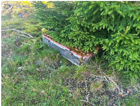
Bølgeeternitt - spesialavfall, spesielt regelverk for håndtering og deponering gjelder.
