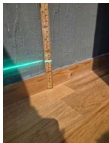
Målt høydeforskjell på soverom 1.
