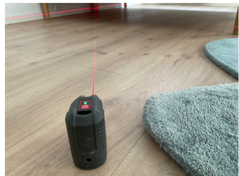
Nivellering soverom, ingen registrerte avvik
