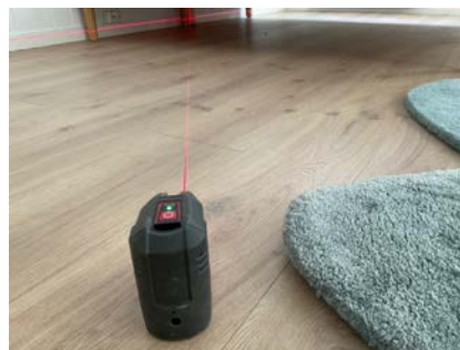
Nivellering soverom, ingen registrerte avvik
