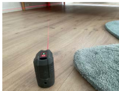
Nivellering soverom, ingen registrerte avvik
