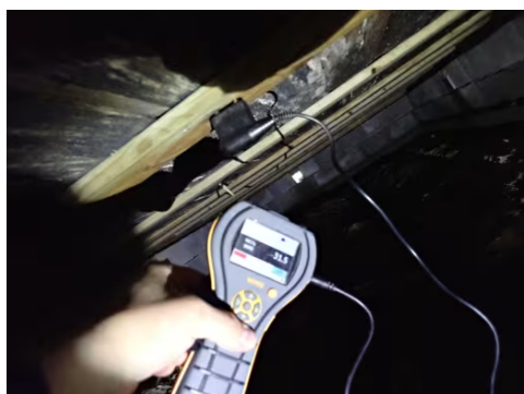
Fuktmåling i kryprom under tilbygg fra 2001.
