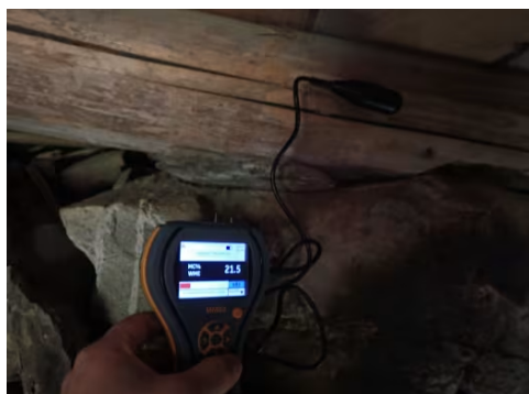
Fuktmåling i kryprom under tilbygg fra 2001.
