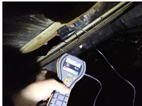
Fuktmåling i treverk i kryprom.
