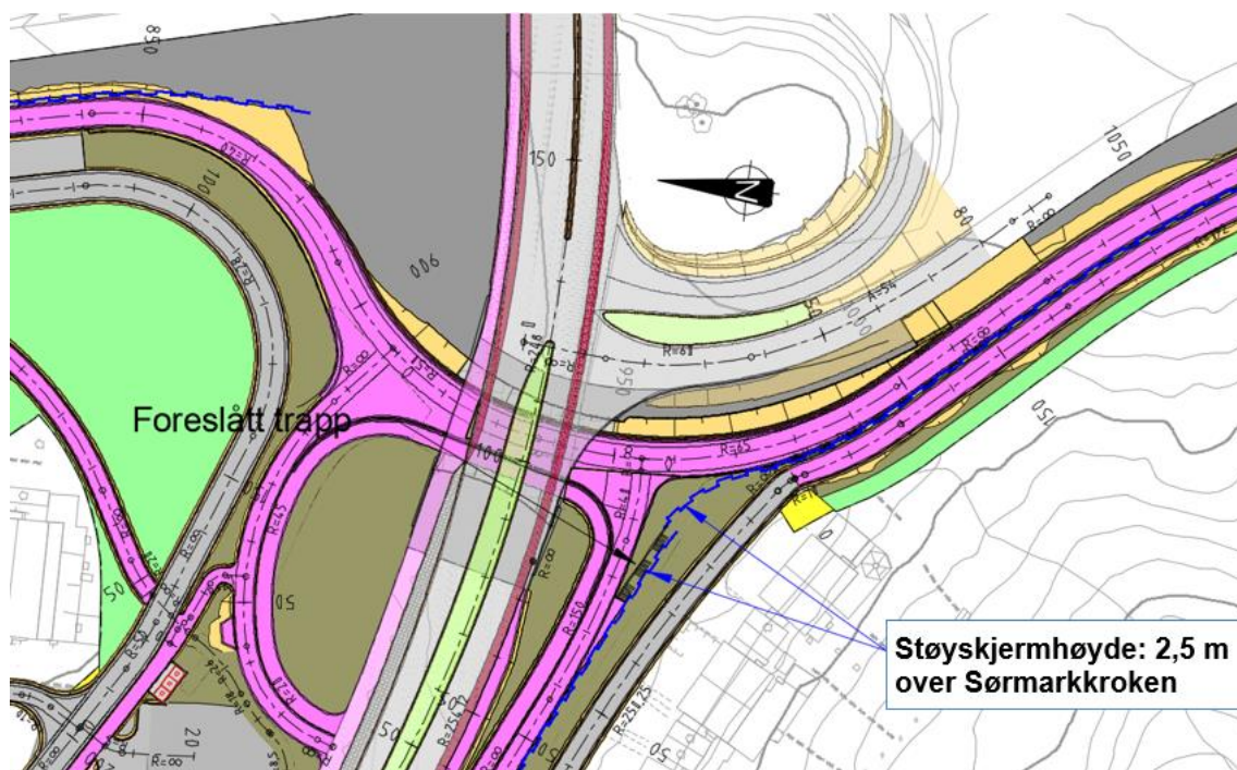
Illustrasjon 3: Støyskjermsløsning ved Auglendsveien
