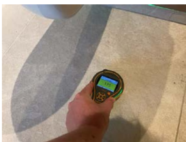
Med enkle fuktsøk ble det ikke registrert unormale verdier.
