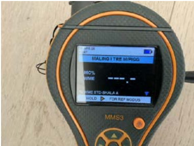
Måling av fukt i treverk. Målinger er foretatt uten å påvise unormale forhold.
