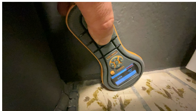
Påvist variable fuktverdier på nedre del av grunnmur og betongsåle.
