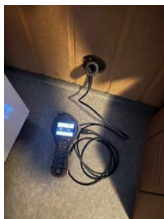
Utført hulltaking på rom under terreng.
