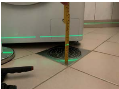
Målt fall til sluk: 22mm.
