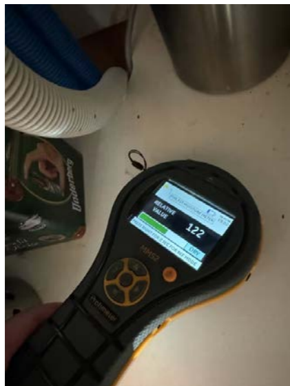
Ingen forhøyde fuktverdier registrert i kjøkkenskap under vask.
