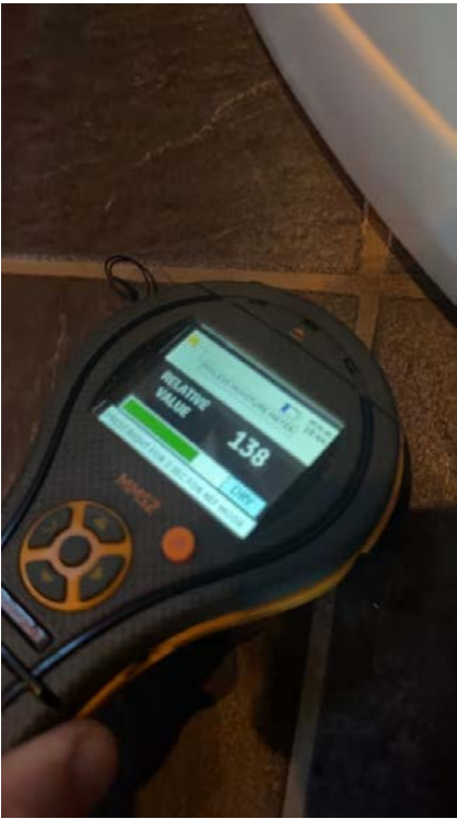
Det ble ikke registrert forhøyede fuktverdier ved brukt av fuktindikator på bad.
