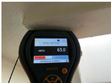
Høyt trefukttinnhold i innvendig karmlist under takvindu.
