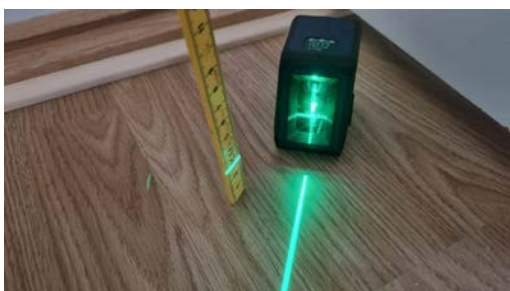
Kontroll av planavvik.
