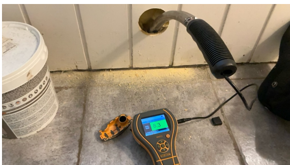
Ingen fuktslag registrert ved fuktmåling i vegg
