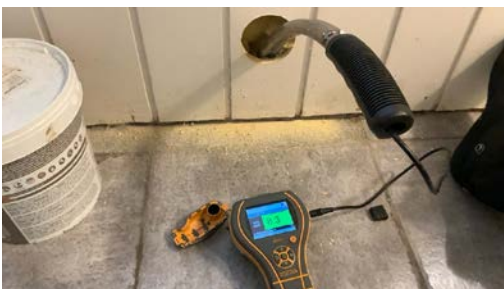
Ingen fuktutslag registrert ved fuktmåling i vegg
