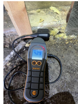
Ved fuktmåletaking av trevirke mot gulv på grunn og mot yttermurer er det fukt og påbegynnende muggsopp
