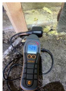
Ved fuktmåletaking av trevirke mot golv på grunn og mot yttermur er det fukt og påbegynnende muggsopp
