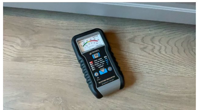
Ingen registrert fukt rundt utsatte hvitevarer.
