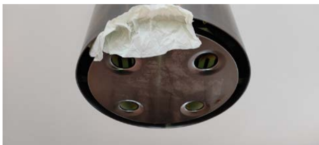
Funksjonstest av ventilator.
