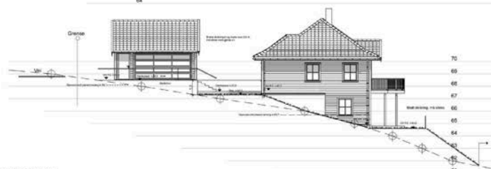
FASADE MOT ØST TERRENGPROFIL 4
