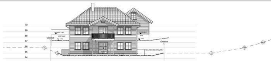
FASADE MOT NORD TERRENGPROFIL 1
