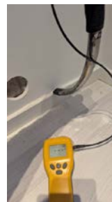
Jeg ønsket ikke å punktere plasten og målte på gipsen.
