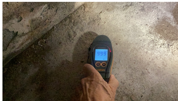
Gulv. Ved enkle fuktsøk ble det registrert områder med forhøyde verdier.
