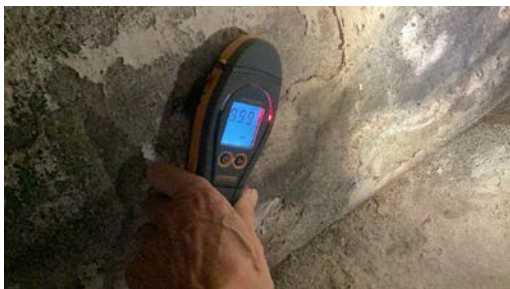
Vegg. Ved enkle fuktsøk ble det registrert områder med forhøyde verdier.
