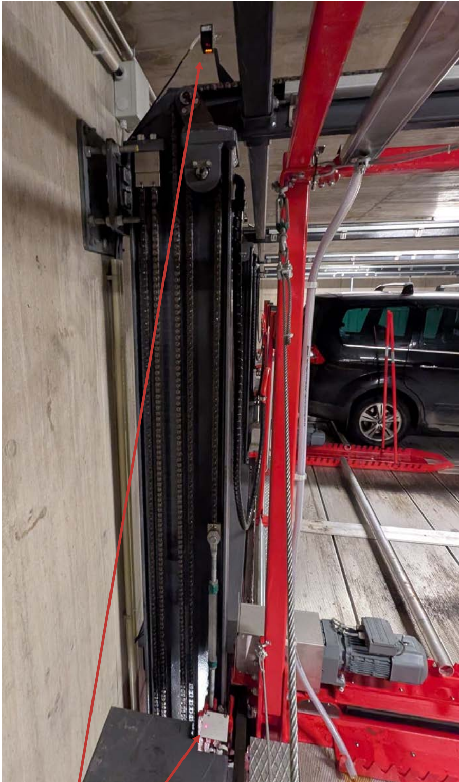
Foto 40: Avstandsmåler og målepunkt for høyde på løft i hjørnet på ramme
