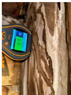
Fuktmåling i sperre på kaldloftet.
