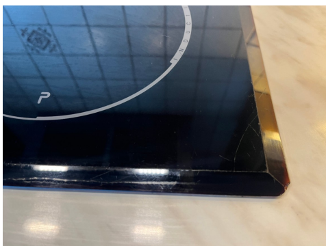
Sprekk i hjørne platetopp.
