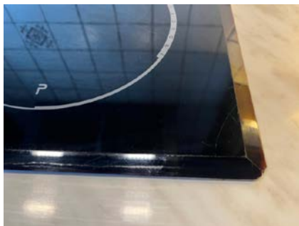
Sprekk i hjørne platetopp.
