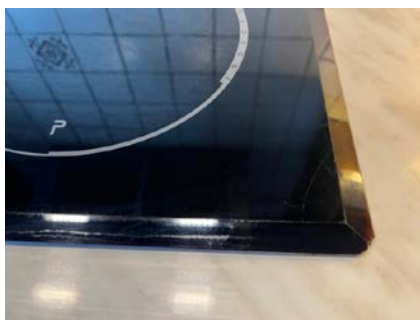
Sprekk i hjørne platetopp.
