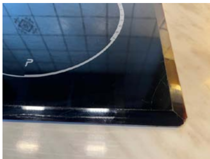
Sprekk i hjørne platetopp.
