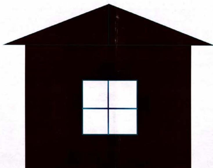
Figur 3 Vest vegg Takutstikk 50 cm Høyde vegg 250 cm Høyde bygg 325 cm
