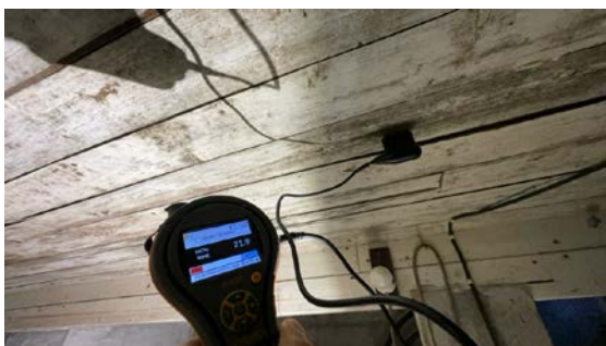
Utført fuktmålinger på himlingsbord mot bjelkelag. Påvist forhøyet fuktprosent.
