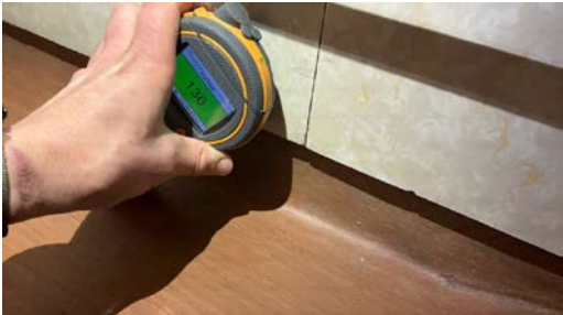
Svelling på veggplater. Enkle fuktsøk viste normale verdier.
