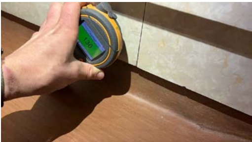
Svelling på veggplater. Enkle fuktsøk viste normale verdier.
