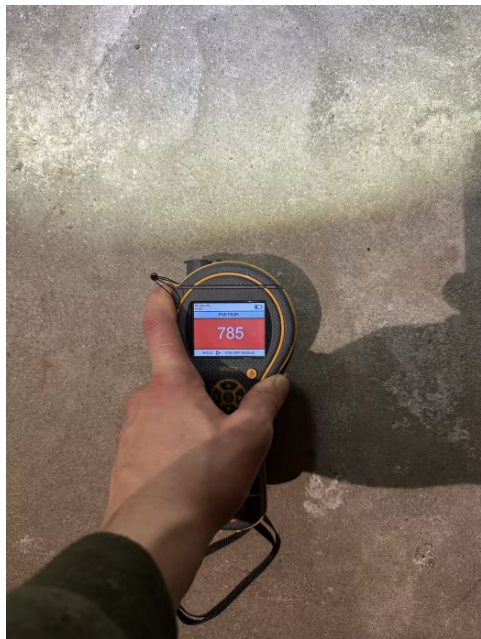
Viser fuktmåling mot kjellergulv.
