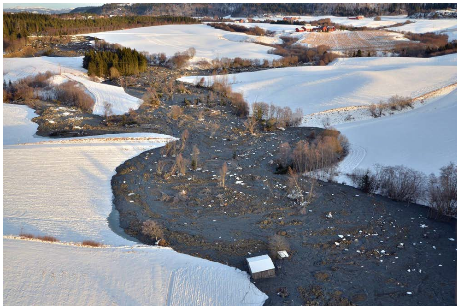
Figur 2.1 Områdeskred utløst av erosjon i en kvikkleiresone på Byneset i Trondheim i 2012. Foto: NVE
