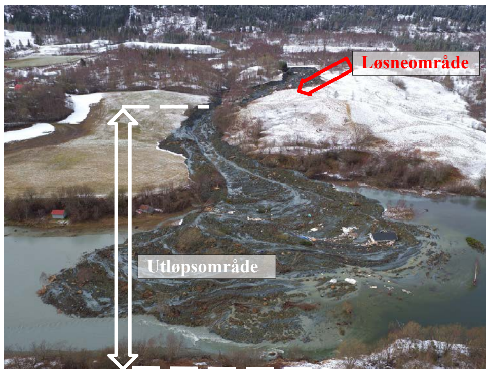
Figur 2.7 Skredet ved Jonsrud i Vefsn 2020, rød pil peker på løsneområdet og hvit pil angir utløpsområdet til skredet. Foto: Dronebilde, Scanflight.
