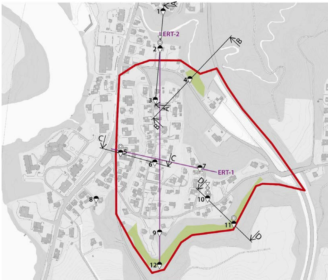
Figur 7.1 Eksempel på borplan for utredning av en kvikkleiresone (faresone) med fire antatt kritiske snitt (A, B, C og D) og to ERT-liner (lilla), 12 borpunkt plassert i og rundt sonen for å gi grunnlag både til beregningssnittene og ERT, samt soneutstrekning. Antatte sikringstiltak etter første runde med beregninger er markert med grønt.
