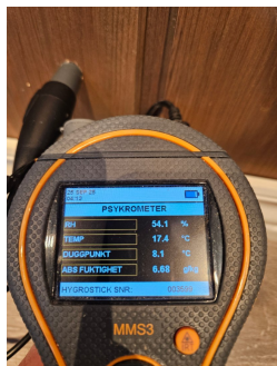
Måling av relativ luftfuktighet i lukket veggkonstruksjon mellom entrè og dusjsone.
