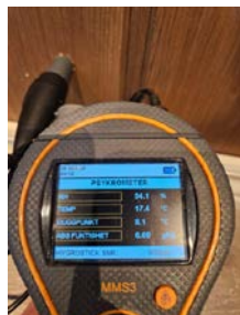
Måling av relativ luftfuktighet i lukket veggkonstruksjon mellom entre og dusjsone.
