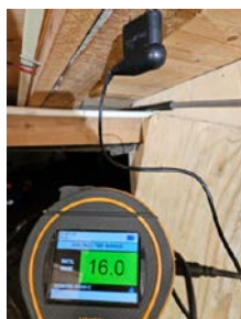
Fuktmåling i bjelkelag under hoveddel.
