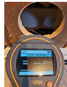
Måling av trefukt i lukket veggkonstruksjon mellom entre og dusjsone.
