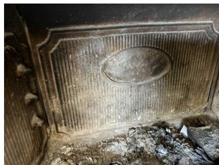
Sprekk i bennplate
