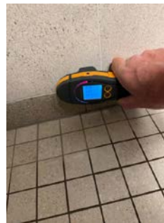
Forhøyede fuktindikasjoner rundt plateskjøter
