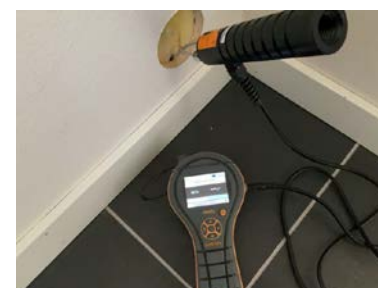
Fuktmåling med måleresultat under 8 % (vektprosent i treverk)
