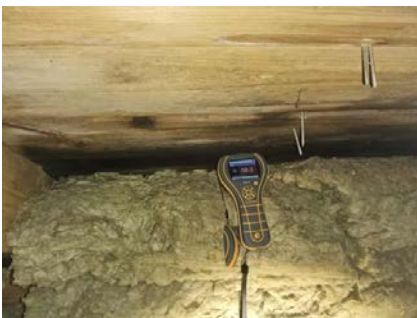
Det ble målt fibermetning i taktro i kott.
