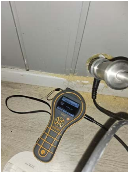
Bilde fra fuktmåling i tilsøtende veggkonstruksjon.
