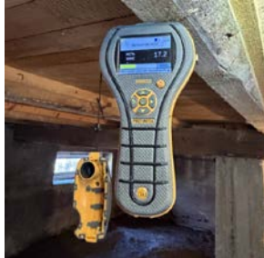
Fuktnivå kontrollert under gulvbjelke
