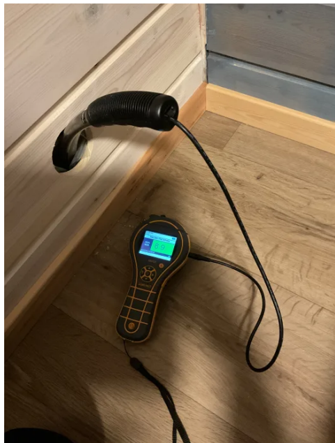
Hulltaking i vegg under terreng.
