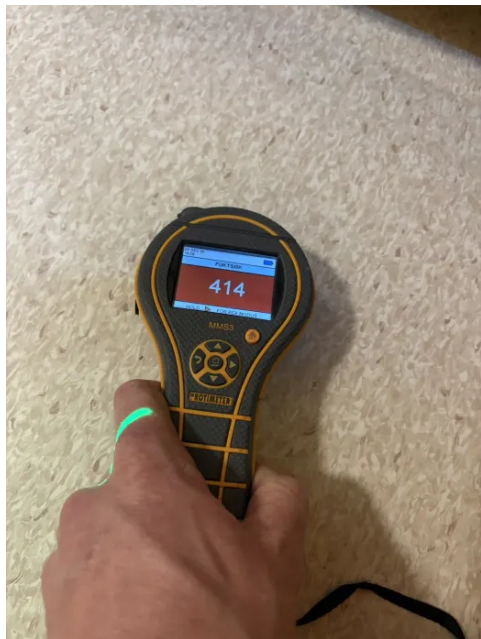
Inndikasjon på fukt.
