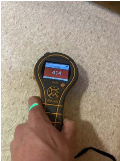
Inndikasjon på fukt.
