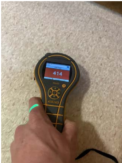
Inndikasjon på fukt.
