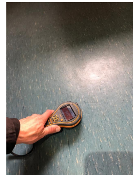
Bilde av overfaldesøk på gulv i underetasjen
